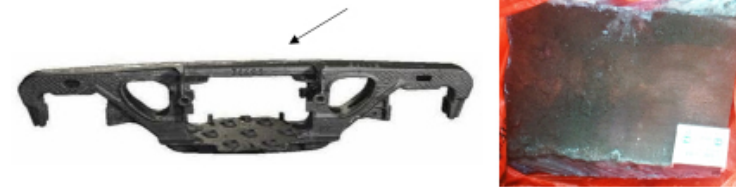
Рисунок 1 – Рама боковая (а) с указанием место выреза и вырезанный фрагмент рамы (б)
