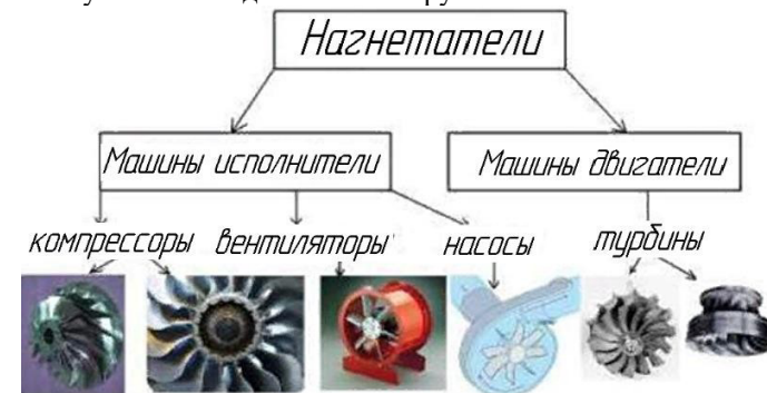
Рисунок 1 – Классификация турбомашин [1, с.7]
