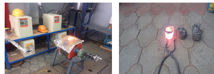
Рисунок 1 – Лабораторная индукционная печь типа GW-MF-25 и опытные слитки стали
